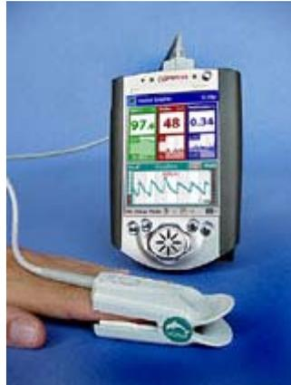
L'oxymètre de pouls Dolphin permet à partir d'une carte compact flash et du logiciel d'avoir la SpO2 et la fréquence cardiaque. Il existe des "minis" saturomètres mais ils ne donnent pas la courbe, essentielle pour s'assurer de l'exactitude du chiffre. Là on a le chiffre, la courbe et les tendances. Le tout est configurable, il y a même des alarmes.
