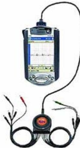
L'EKGCard™ de QRS est l'électrocardiographe le plus petit et le plus léger au monde. Il suffit d'insérer l'EKGCard dans votre Pocket PC ou votre ordinateur pour pouvoir afficher, enregistrer et analyser jusqu'à 12 canaux de données d'électrocardiographe haute résolution.
